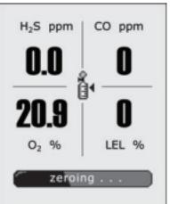
4. При появлении следующего сообщения установите калибровочную крышку и подайте калибровочный газ со скоростью 250–500 мл/мин. См. раздел *«Подсоединение цилиндра с газом к детектору» на стр. 11*
