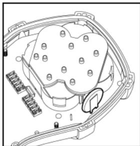
7. Отсоедините четыре контакта по отдельности, чтобы снять плоский круглый аккумулятор.
