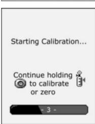
3. Сенсор газоанализатора войдет в функцию обнуления. Пока газоанализатор обнуляет все сенсоры, отображается **zeroing** (обнуление).
